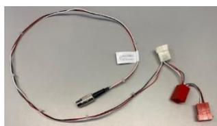
L'Optimo<sup>2</sup> avec sa version 6.0 (FW 2.09) diffusée dans les prochains jours, dispose d'une **nouvelle fonction de lecture des informations du module DSRC externe Stoneridge** par le biais de récupération des informations sur le **CAN, cela sans passer par la VU**. Pour utiliser cette fonction vous devez disposer du câble référence **801422\_01R01**.
